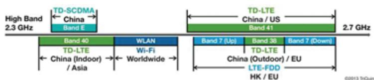
РИС. 1. ДИАПАЗОНЫ ЧАСТОТ TDD LTE, ПРИМЫКАЮЩИЕ К ЧАСТОТАМ WLAN В ДИАПАЗОНЕ 2,4 ГГц
